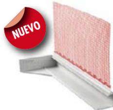
Perfil de conexión e inserción para una ejecución duradera e impermeable del alféizar (alféizares estándar de aluminio, madera, pvc, piedra o alféizares realizados a medida).
