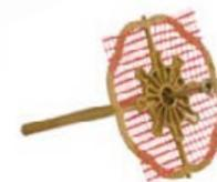
Fijación mecánica suplementaria alternativa al anclaje tradicional, especialmente indicado para la colocación de un doble sistema de aislamiento térmico por el exterior (máx. 90 mm de espesor).
