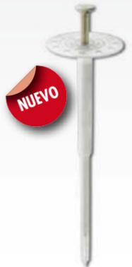
Espiga de percusión con clavo de acero recubierta de plástico para reducir el puente térmico. Gran resistencia de cargas para paneles aislantes de EPS y Lana Mineral. Cabeza de anclaje combinable con otros platillos. Posee EPD (Environmental Product Declaration).
