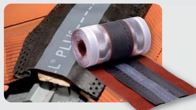
Material: Faldas laterales de aluminio moldeable y deformable hasta un 50%, tiene en su zona central de polipropileno hidrófugo un doble canal de ventilación y un sistema de aperturas geométricas para una ventilación (150 cm<sup>2</sup>/ml) optimizada y una protección total contra los elementos exteriores.
