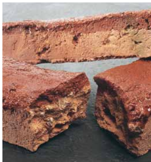
Detalle del alto poder de penetración de un consolidante al disolvente ▲
