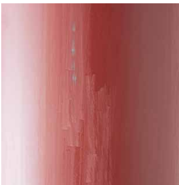
Imagen derecha: la misma operación de raspado, realizada sobre un bajante cubierto con la imprimación TodoTerreno al agua , de Beissier . En este caso, se aprecia que la pintura no se desprende como lo hace en la figura de la izquierda.
