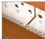
Los perfiles de arranque deben situarse a una altura mínima de 15 cm del suelo para evitar la degradación del sistema por contacto directo con el terreno y, si el soporte fuera muy irregular, deberán ser colocados sobre una banda de mortero base para evitar oquedades entre aislamiento y soporte. La parte inferior debe impermeabilizarse mediante la aplicación de **weber.tec imperflect**. Con ello se impide la penetración de agua del terreno a través del interior del sistema **weber.therm**.
