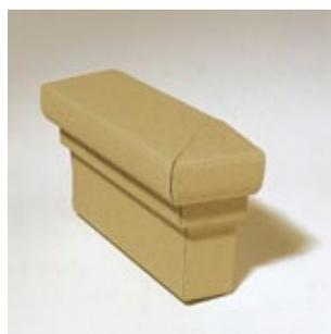
Se cortan los perfiles para fachada en un ángulo de 45°. Después se aplica Austrotherm *Pu-Stoßfugenkleber* en los cantos y se unen los mismos. Se fijan los perfiles de alféizar cortados a medida con los perfiles preparados en el inglete debajo del alféizar.
